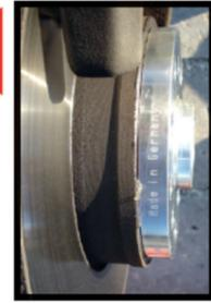
**10** Korrosionsschutzpaste im Bereich der Zentrierung dünn auftragen. Apply a thin layer of corrosion protection paste to the centering flange on the spacer.
