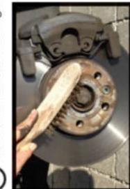
**8** Prüfen ob die Distanzscheibe vollflächig an der Nabenanlagefläche der Felge anliegt.
