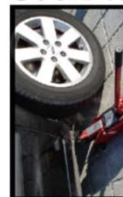
**2** Wagenheber an der dafür vorgesehenen Stelle ansetzen und Rad leicht entlasten. Position the lifting jack off the wheel.
