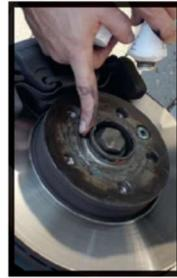
**11** Die neuen, längeren Befestigungsmittel auf Länge und Typ prüfen, vgl. umseitige Schraubenhinweise. Die neuen Radbefestigungsmittel müssen um Scheibenstärke länger als die ursprünglichen Befestigungsmittel sein.
