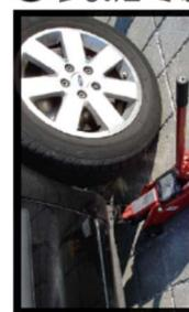
**2** Wagenheber an der dafür vorgesehenen Stelle ansetzen und Rad leicht entlasten. Position the lifting jack off the wheel, and take the pressure off the wheel.
